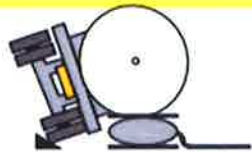
Повдигане с пневматични възглавници
