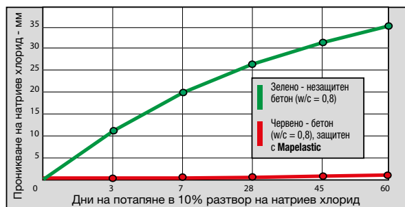
Фиг. 3: защита с Mapelastic срещу проникване на натриев хлорид в порест бетон
