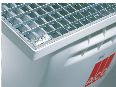
Мрежеста решетка с големина на отворите 30x30 mm, носимоспособност до 1.5 kN
