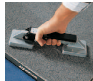
Attrezzo di sollevamento dei pannelli con finitura tessile. Lifting-tool with needles for carpet.
